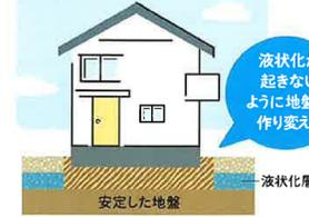
例:砂杭や丸太で地盤を締固める工法 など
